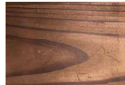
E's-WOOD(杉)は薬品を一切使用せず窒素加熱処理を行うことで、木の腐りやすい成分を分解し耐久性を向上させたものになります。
