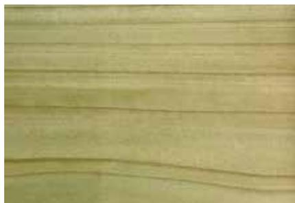
桧(間伐材)ACQは防腐・防蟻性能を持つ薬液を(水溶性木材保存剤)を加圧注入し乾燥させたもので、木材に塗布ではなく加圧注入をするため木材内部まで薬液が浸透し、防腐・防蟻効果が長持ちします。
